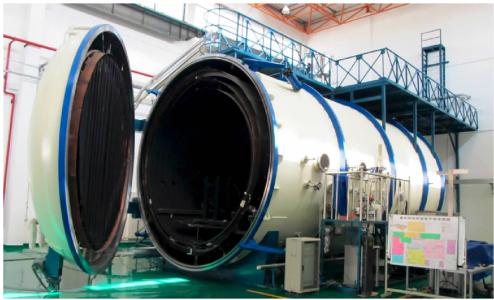
图 1 真空羽流效应实验系统 (PES)
